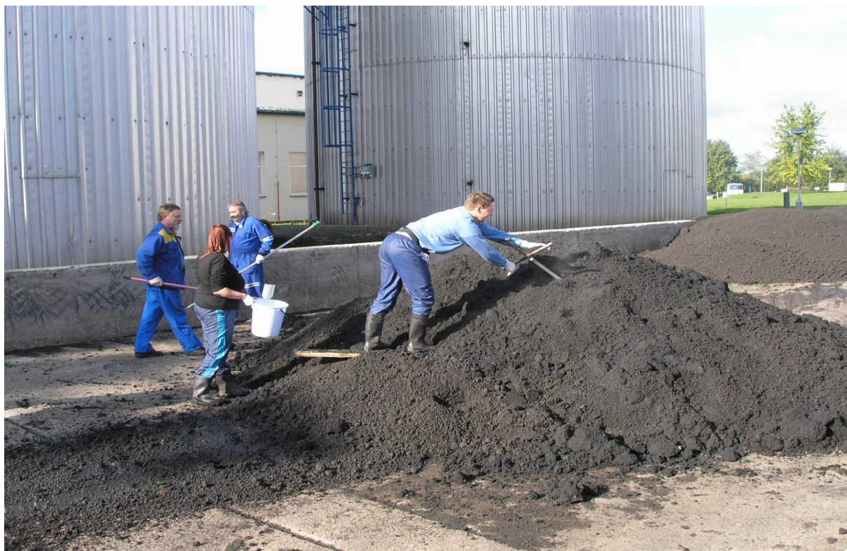
Obr. 1 – Vzorkování čistírenských kalů - vyvážka
