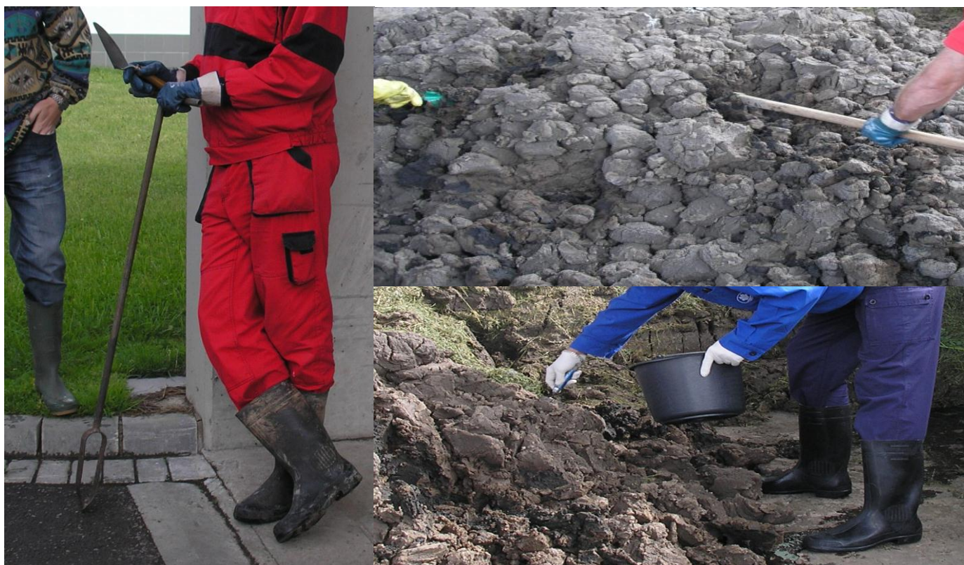
Obr. 2 – Vzorkování čistírenských kalů - technika odběru
