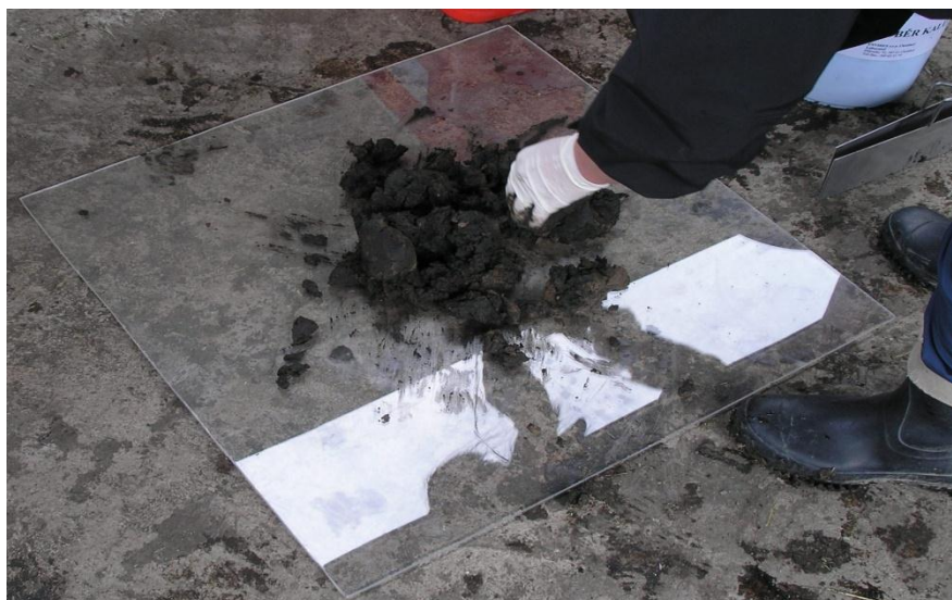
Obr. 3 – Vzorkování čistírenských kalů - zpracování vzorku na lokalitě
