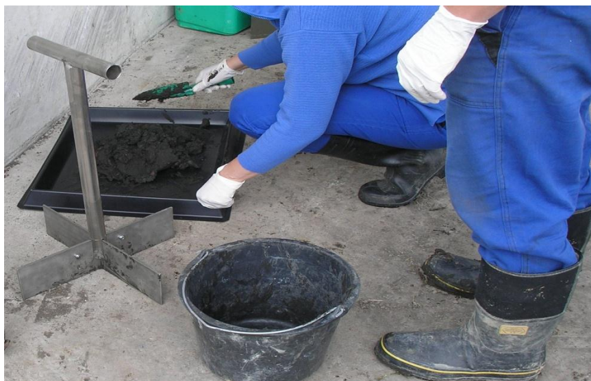
Obr. 3 – Vzorkování čistírenských kalů - zpracování vzorku na lokalitě – pokračování
